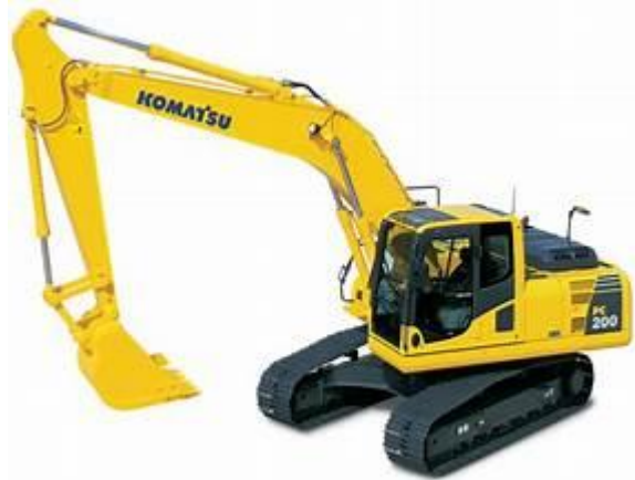
6. Excavator (PC200, PC300, PC400): Excavator digunakan untuk menggali dan memindahkan material dari kedalaman tertentu. Alat ini cocok untuk pekerjaan yang membutuhkan penggalian tanah atau batuan dalam volume besar. Excavator juga sering digunakan untuk memindahkan batu bara dari tempat penambangan ke lokasi penimbunan.
