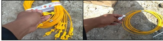
Gambar 4.10 Inhole delay 500ms dan 6000ms
