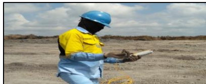
Gambar 4.19 Pemasangan in-hole delay pada dynamite ( Priming )
