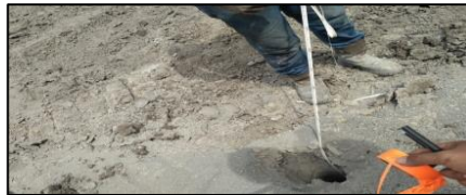
Gambar 4.18 Pengukuran kedalaman lubang ( sounding )
