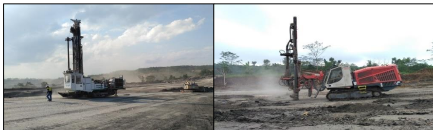
ambar 4.17 Unit Drilling Reichdrill (kiri) dan Sandvik (kanan)
