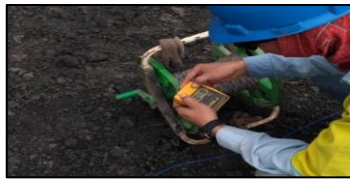
Gambar 4.24 Check tahanan lead wire dengan Ohm meter
