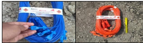
Gambar 4.11 Surface Delay 109ms(kiri) dan 67ms(kanan)
