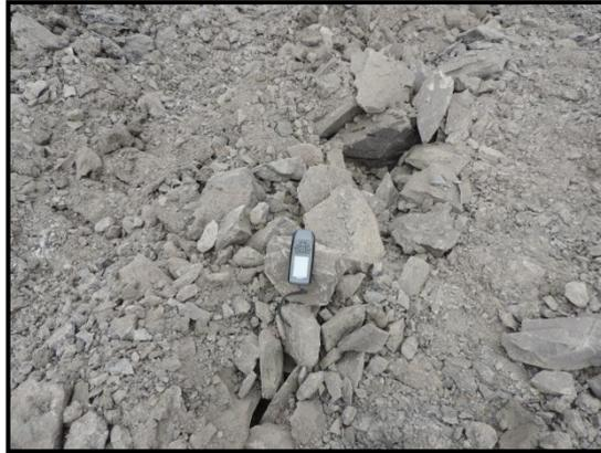
Gambar 3. Sampel Hasil Bongkaran Alat Garu
