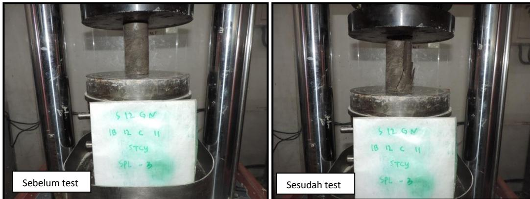
Gambar 4. Hasil Pengujian Kuat Tekan Sebelum dan Sesudah Pengujian
