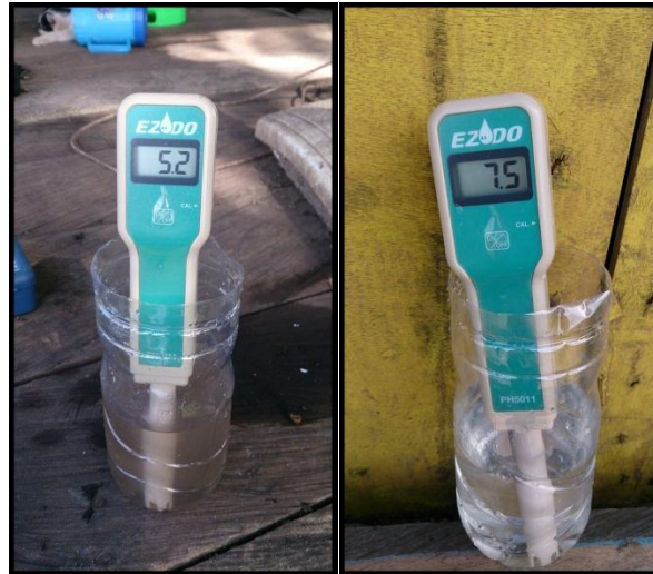
Gambar 2. Pengukuran Kadar pH Pada Inlet (Kiri) dan Pengukuran Kadar pH Pada Outlet (Kanan)
