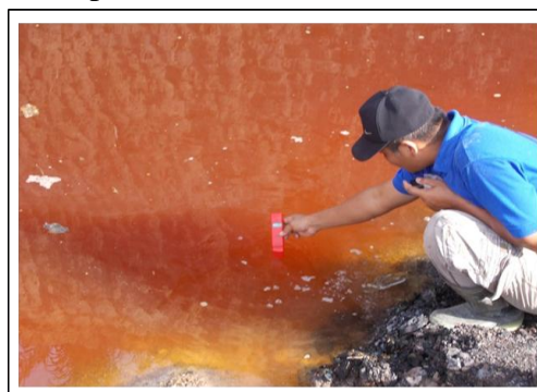
Gambar 3.13. Air Pit tambang warna coklat kemerahan akibat pengaruh dari mineral pirit atau sejenisnya yang terdapat pada batulempung atau coalyshale.
