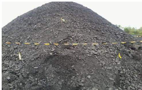
Gambar.2. Bentuk Tumpukan Single Cone
