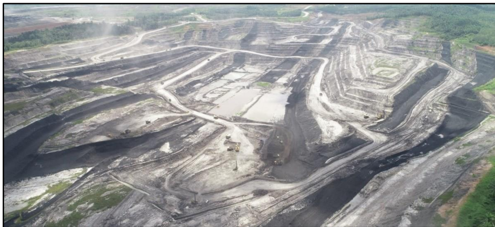
Gambar Kondisi Pit LSA yang tergenang akibat air limpasan permukaan
