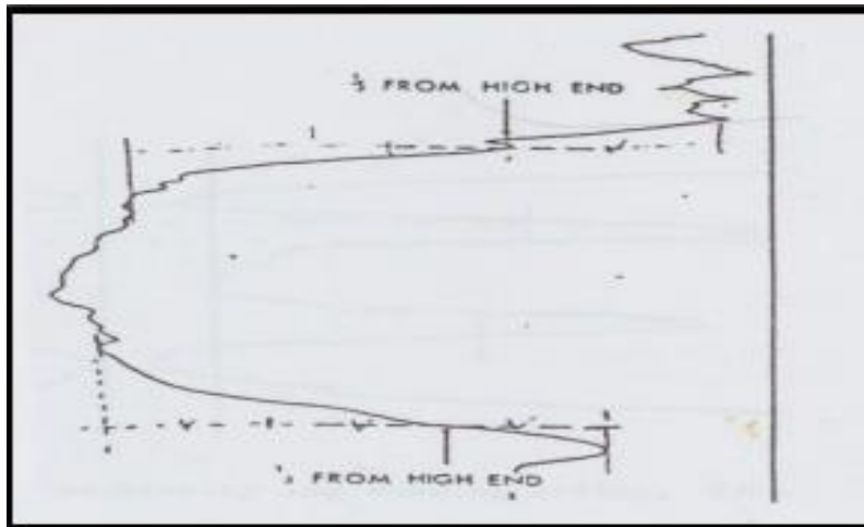
Penentuan ketebalan dengan menggunakan gamma ray log (Ellis&Singer,2008)
